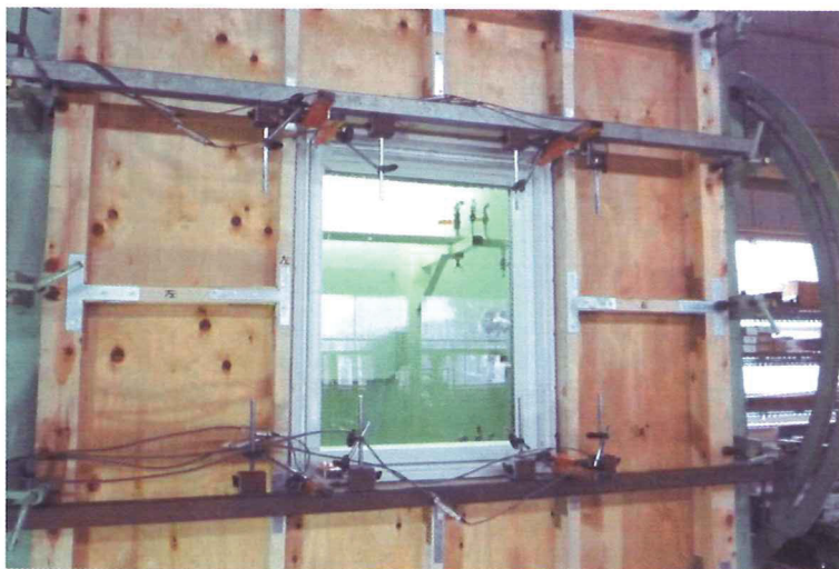
写真 4.3 耐風圧性 試験実施状況
